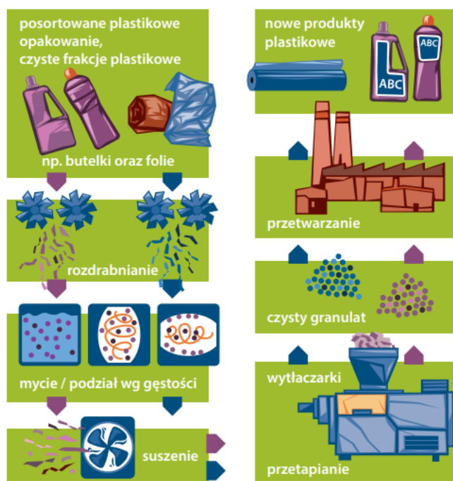
Rysunek 13. Schemat recyklingu odpadów z tworzyw sztucznych
