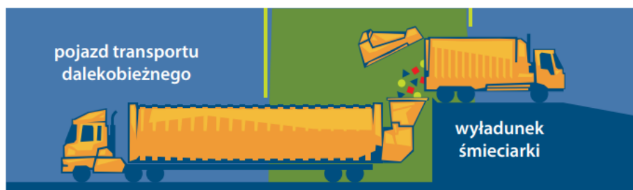
Rysunek 15. Przeładowanie odpadów ze śmieciarki bezpośrednio na pojazd transportu dalekobieżnego
