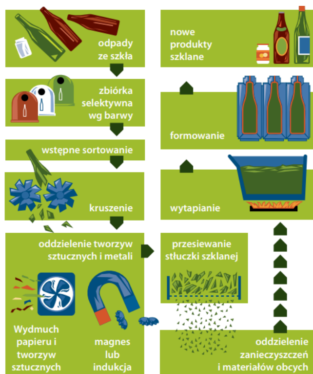
Rysunek 12. Schemat przetwarzania odpadów szklanych w Niemczech
