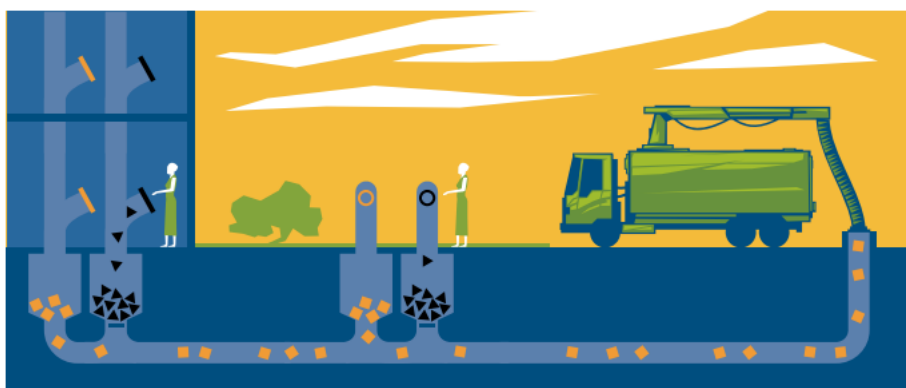
Rysunek 22. Schemat działania mobilnego systemu pneumatycznej zbiórki odpadów
